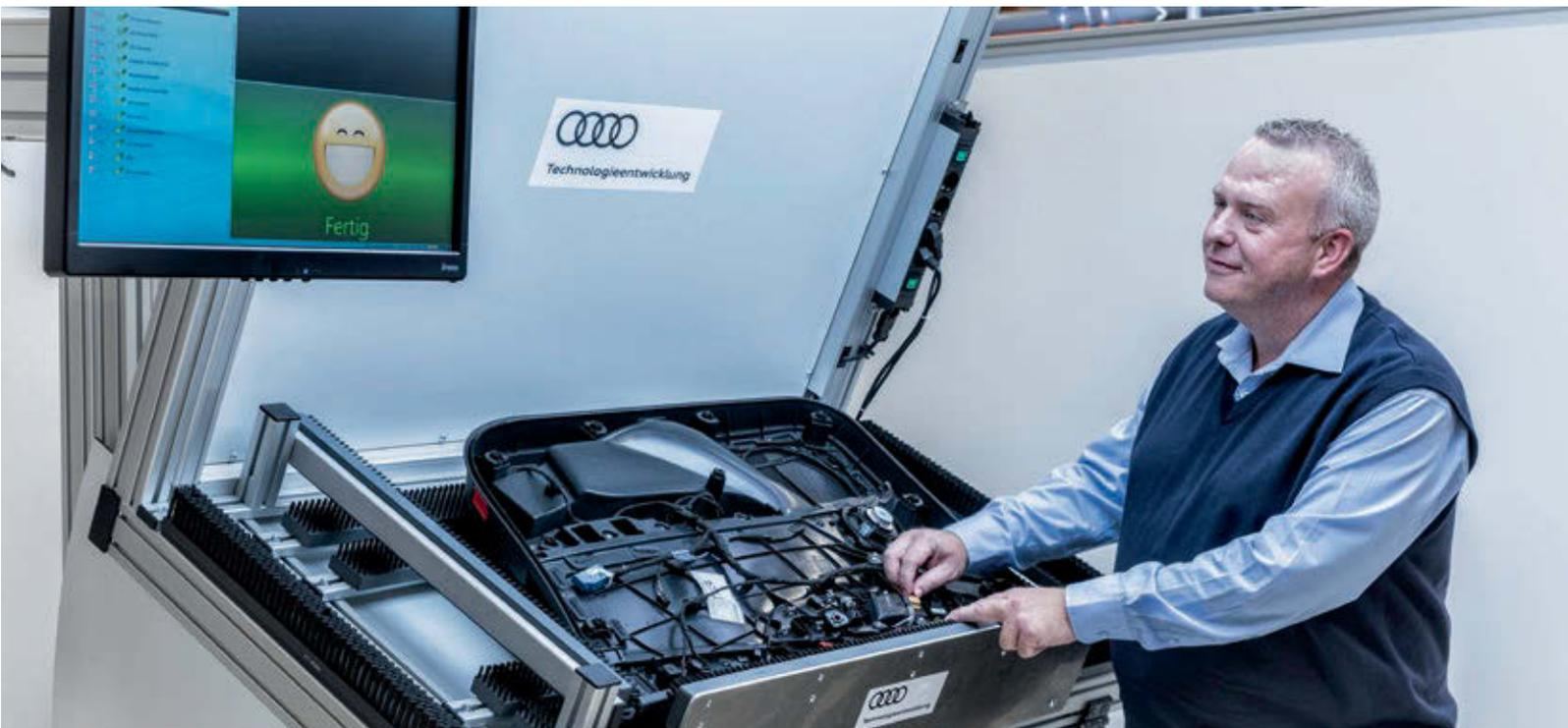
Assistenzsysteme ermöglichen 100 %-Qualität und die Beherrschung hoher Variantenkomplexität in der Handmontage.
