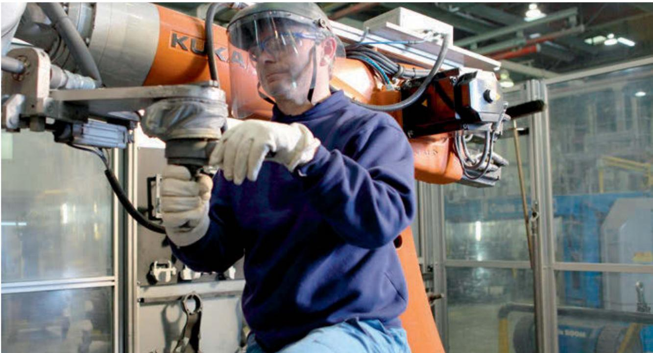
Intuitiver programmieren geht nicht: Der Werker führt den Roboter einfach und die Bahn ist programmiert.
